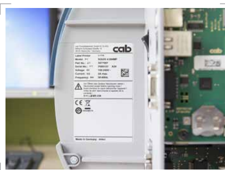
Identificación de placas de características
