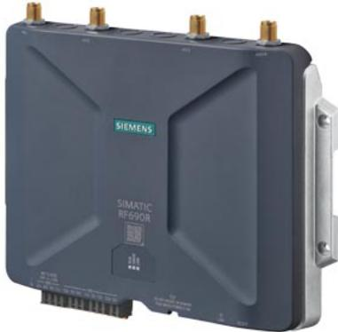
lector SIMATIC RF600 RF690R ETSI; Ethernet RJ45 PoE 4 antenas, 1 DI / DO, 24 V DC; de -25 a +55 °C; sin accesorios ni antenas
