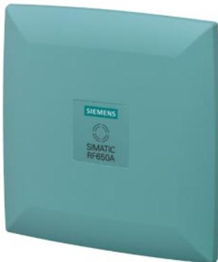
antena SIMATIC RF600 RF650A; circular, rango de frecuencia de 865 a 928 MHz de banda ancha dimensiones 198 × 198 × 60 mm (L × An × Al); IP65, de -25 a +75 °C.
